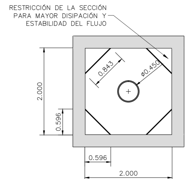
CORTE 1-1 DETALLE SECCIÓN
